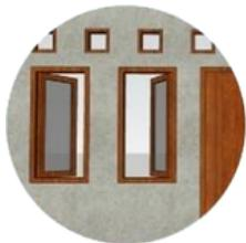
Luas pencahayaan minimal 10% dari luas lantai; luas penghawaan minimal 5% dari luas lantai
