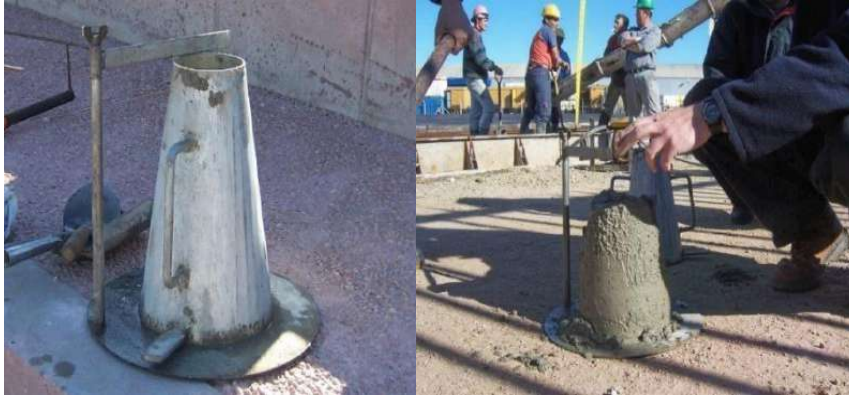
Gambar II-29 Contoh Pelaksanaan Pengujian Slump Test
