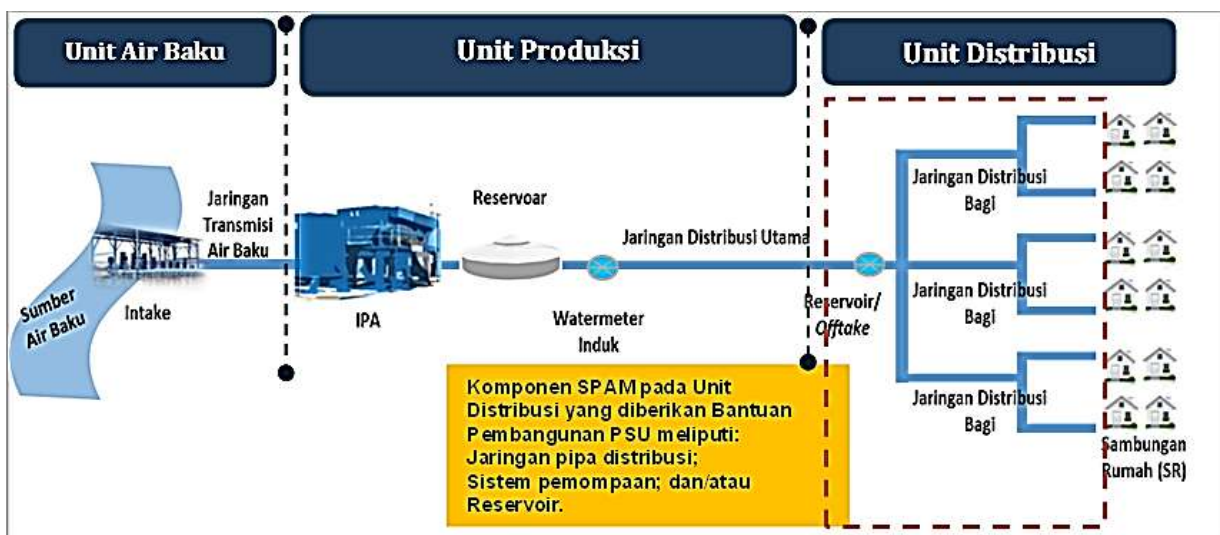
Gambar I-19 Batas Penanganan Bantuan Pembangunan PSU Perumahan Tapak Berupa Penyediaan Air Minum Pada Unit Distribusi
