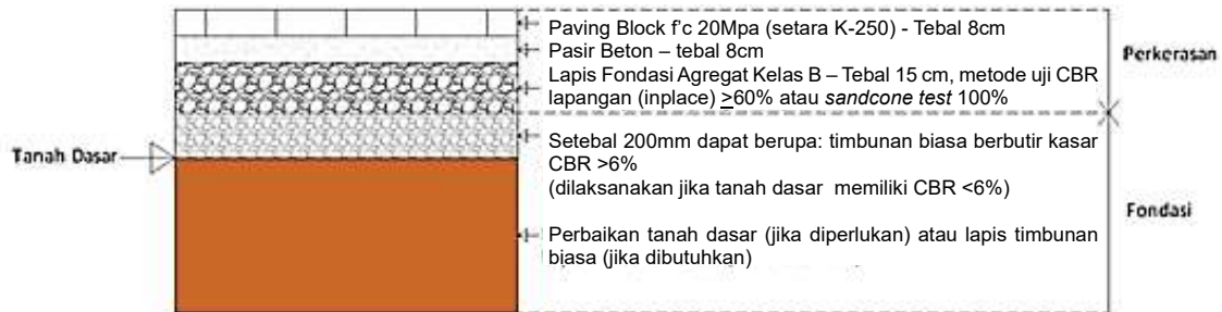
Gambar II-3 Potongan Lapis Perkerasan Paving Block Jika Nilai CBR Tanah Dasar atau Tanah Asli < 6\%
