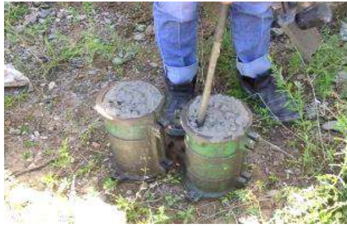
Gambar I-48 Contoh Pengambilan Sampling Benda Uji Silinder Beton
