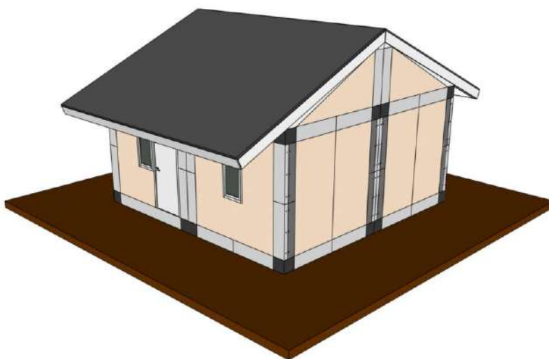
Gambar IV- 14 Pemasangan Panel Dinding, Panel Jendela, Panel Pintu Dan Panel Ampig Sumber: (1) Modul Program Bantuan RITTA, Direktorat Rumah Umum dan Komersial, Kementerian PUPR Tahun 2024 dan (2) Pedoman Konstruksi Bangunan RPT-0: ST/Risha 16 Tata Cara Komponen-Komponen RSH Sistem Risha, Puslitbang Perumahan dan Permukiman Terbitan 2019
