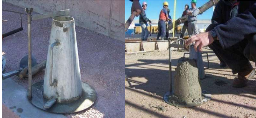
Gambar I-49 Contoh Pelaksanaan Pengujian Slump Test
