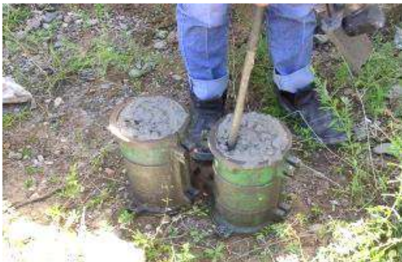
Gambar III-27 Contoh Pengambilan Sampling Benda Uji Silinder Beton
