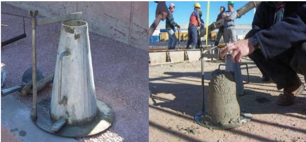
Gambar III-28 Contoh Pelaksanaan Pengujian Slump Test
