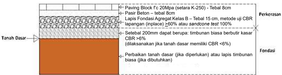
Gambar I-6 Potongan Lapis Perkerasan Paving block Jika Nilai CBR Tanah Dasar atau Tanah Asli < 6%
