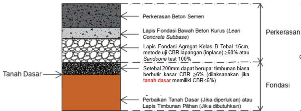
Gambar II-2 Potongan Lapis Perkerasan beton semen Jika Nilai CBR Tanah Dasar atau Tanah Asli < 6\%
