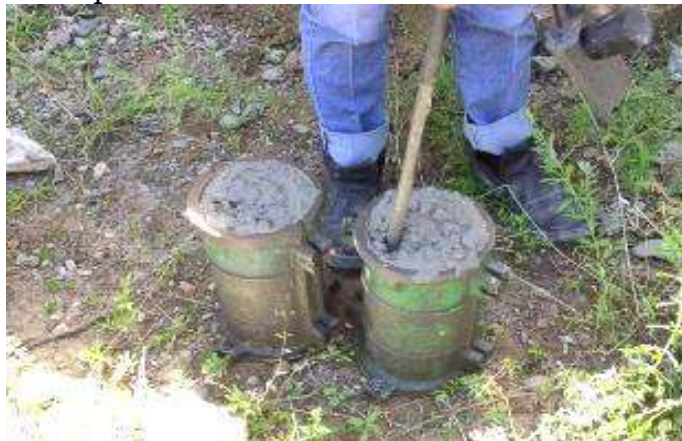
Gambar II-28 Contoh Pengambilan Sampling Benda Uji Silinder Beton
